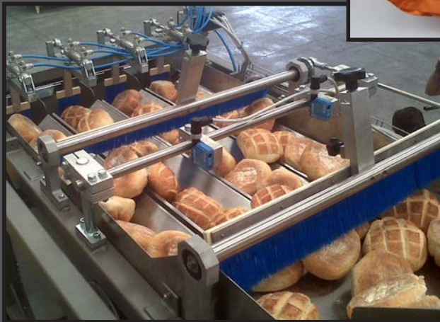
Anlage mit Zähleinrichtung
