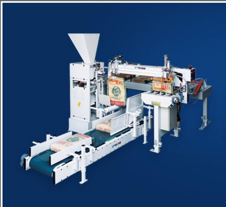
Ventilbeutel Füller mit automatischer Zuführung
