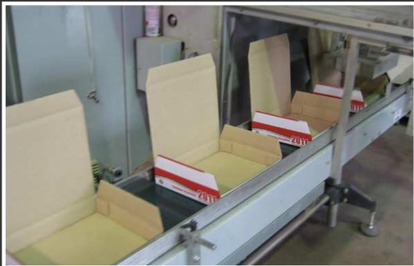
Komplette Linien für halb- oder vollautomatische Befüllung mit Kartonverschluss mittels Klebeband oder Heißleim und automatischer Palettierung
